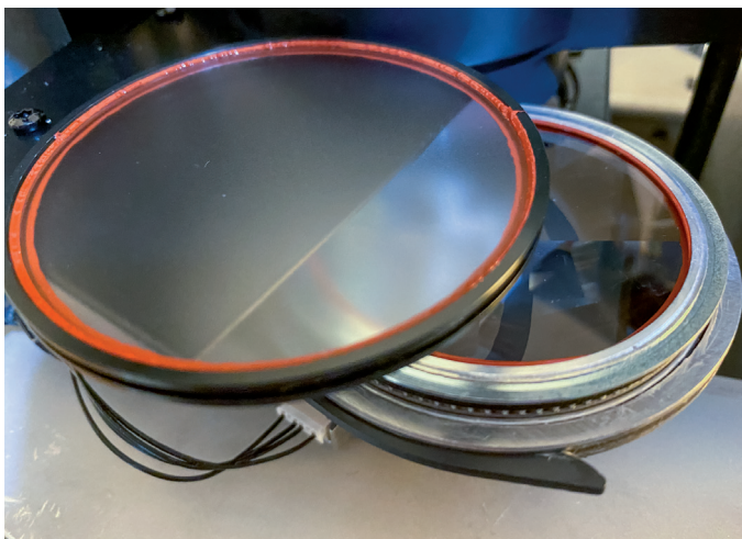
Optional erhältlich Heavy Frost kann das Prisma ersetzen, rechts im direkten Vergleich zum Medium Frost
